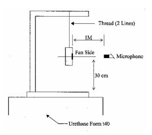
1 METER FROM MICROPHONE TO FAN INTAKE
