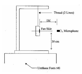
1 METER FROM MICROPHONE TO FAN INTAKE
