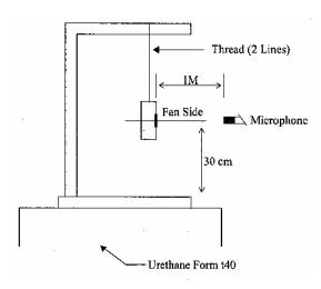
1 METER FROM MICROPHONE TO FAN INTAKE
