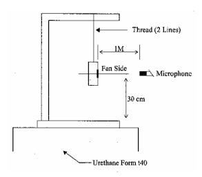
1 METER FROM MICROPHONE TO FAN INTAKE
