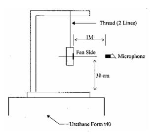
1 METER FROM MICROPHONE TO FAN INTAKE
