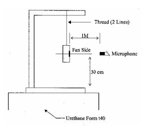
1 METER FROM MICROPHONE TO FAN INTAKE
