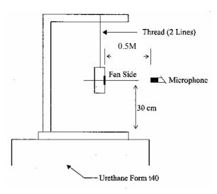
0.5 METER FROM MICROPHONE TO FAN INTAKE
