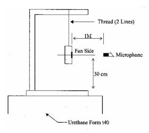
1 METER FROM MICROPHONE TO FAN INTAKE
