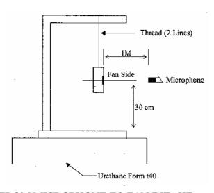
1 METER FROM MICROPHONE TO FAN INTAKE
