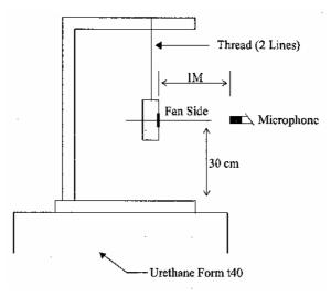
1 METER FROM MICROPHONE TO FAN INTAKE
