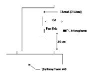
1 M METER FROM MICROPHONE TO FAN INTAKE
