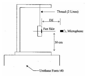
1 METER FROM MICROPHONE TO FAN INTAKE
