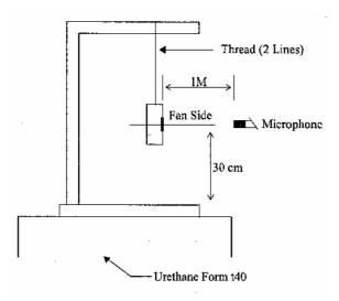
1 METER FROM MICROPHONE TO FAN INTAKE
