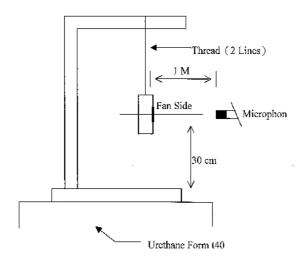
1 METER FROM MICROPHONE TO FAN INTAKE
