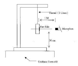
1 METER FROM MICROPHONE TO FAN INTAKE
