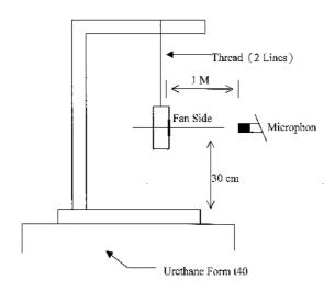
1 METER FROM MICROPHONE TO FAN INTAKE
