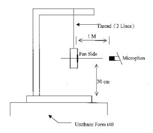
1 METER FROM MICROPHONE TO FAN INTAKE
