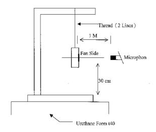
1 METER FROM MICROPHONE TO FAN INTAKE
