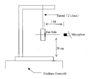
1 METER FROM MICROPHONE TO FAN INTAKE
