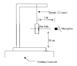
1 METER FROM MICROPHONE TO FAN INTAKE
