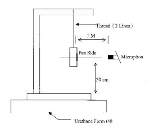
1 METER FROM MICROPHONE TO FAN INTAKE
