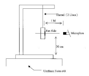
1 METER FROM MICROPHONE TO FAN INTAKE
