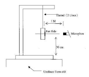
1 METER FROM MICROPHONE TO FAN INTAKE
