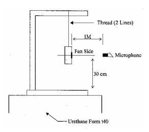
1 METER FROM MICROPHONE TO FAN INTAKE
