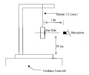
1 METER FROM MICROPHONE TO FAN INTAKE
