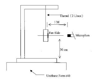
1 METER FROM MICROPHONE TO FAN INTAKE
