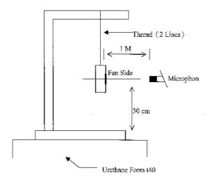
1 METER FROM MICROPHONE TO FAN INTAKE
