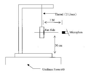
1 METER FROM MICROPHONE TO FAN INTAKE
