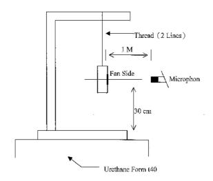
1 METER FROM MICROPHONE TO FAN INTAKE
