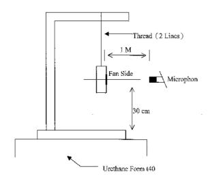
1 METER FROM MICROPHONE TO FAN INTAKE
