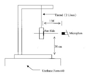
1 METER FROM MICROPHONE TO FAN INTAKE
