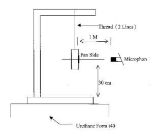
1 METER FROM MICROPHONE TO FAN INTAKE
