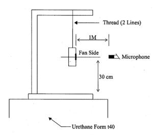
1 METER FROM MICROPHONE TO FAN INTAKE
