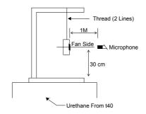
1 METER FROM MICROPHONE TO FAN INTAKE
