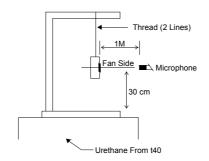
1 METER FROM MICROPHONE TO FAN INTAKE
