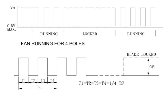
N=R.P.M TS=60/N(SEC) \*VOLTAGE LEVEL AFTER BLADE LOCKED \*4 POLES
