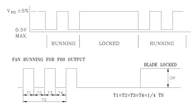
N=R.P.M TS=60/N(SEC) \*VOLTAGE LEVEL AFTER BLADE LOCKED
