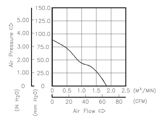
\*TEST CONDITION: INPUT VOLTAGE-----OPERATION VOLTAGE TEMPERATURE-----ROOM TEMPERATURE HUMIDITY-----65%RH
