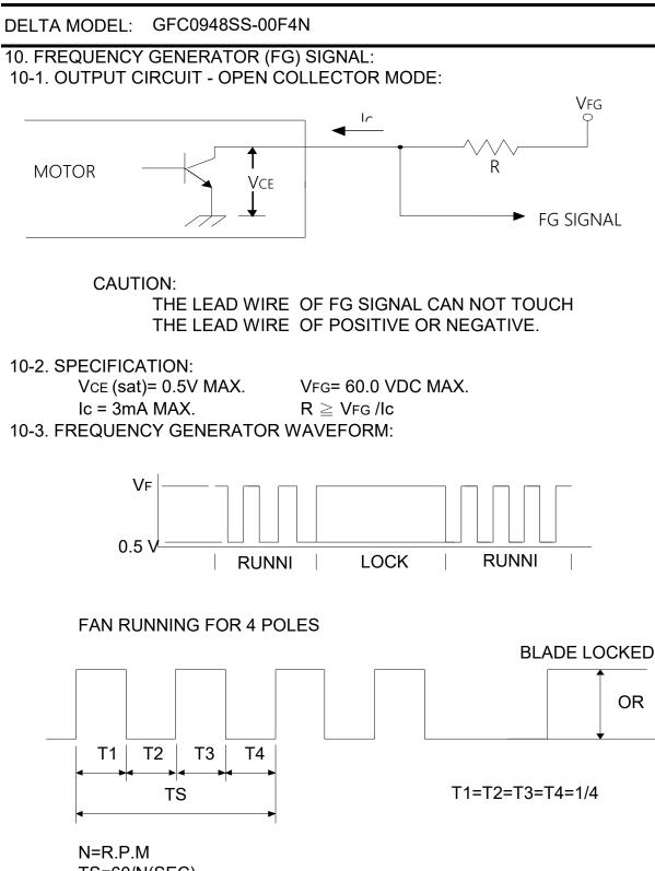
N=R.P.M TS=60/N(SEC) \*VOLTAGE LEVEL AFTER BLADE LOCKED \*4 POLES
