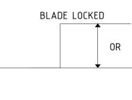
N=R.P.M TS=60/N(SEC) \*VOLTAGE LEVEL AFTER BLADE LOCKED \*4 POLES
