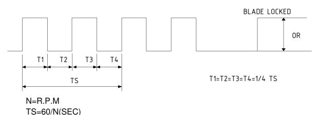
\*VOLTAGE LEVEL AFTER BLADE LOCKED
